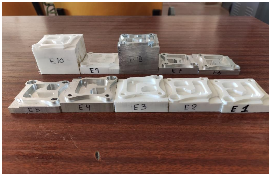
Ilustración 19: Piezas mecanizadas del ensayo de tolerancias geométricas y dimensionales
